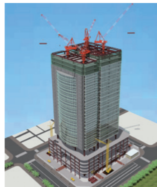
施工段階におけるBIMの3次元モデル活用イメージ(提供:GSA株式会社)
